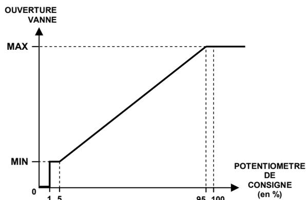
**Réglage de l'ouverture MIN :** Positionner le potentiomètre de face avant à 0 (butée lorsque que l'on tourne le potentiomètre dans le sens anti-horaire). Puis tourner le légèrement dans l'autre sens jusqu'à ce que la led clignote. Régler l'ouverture minimale avec le potentiomètre MIN de la face arrière.
